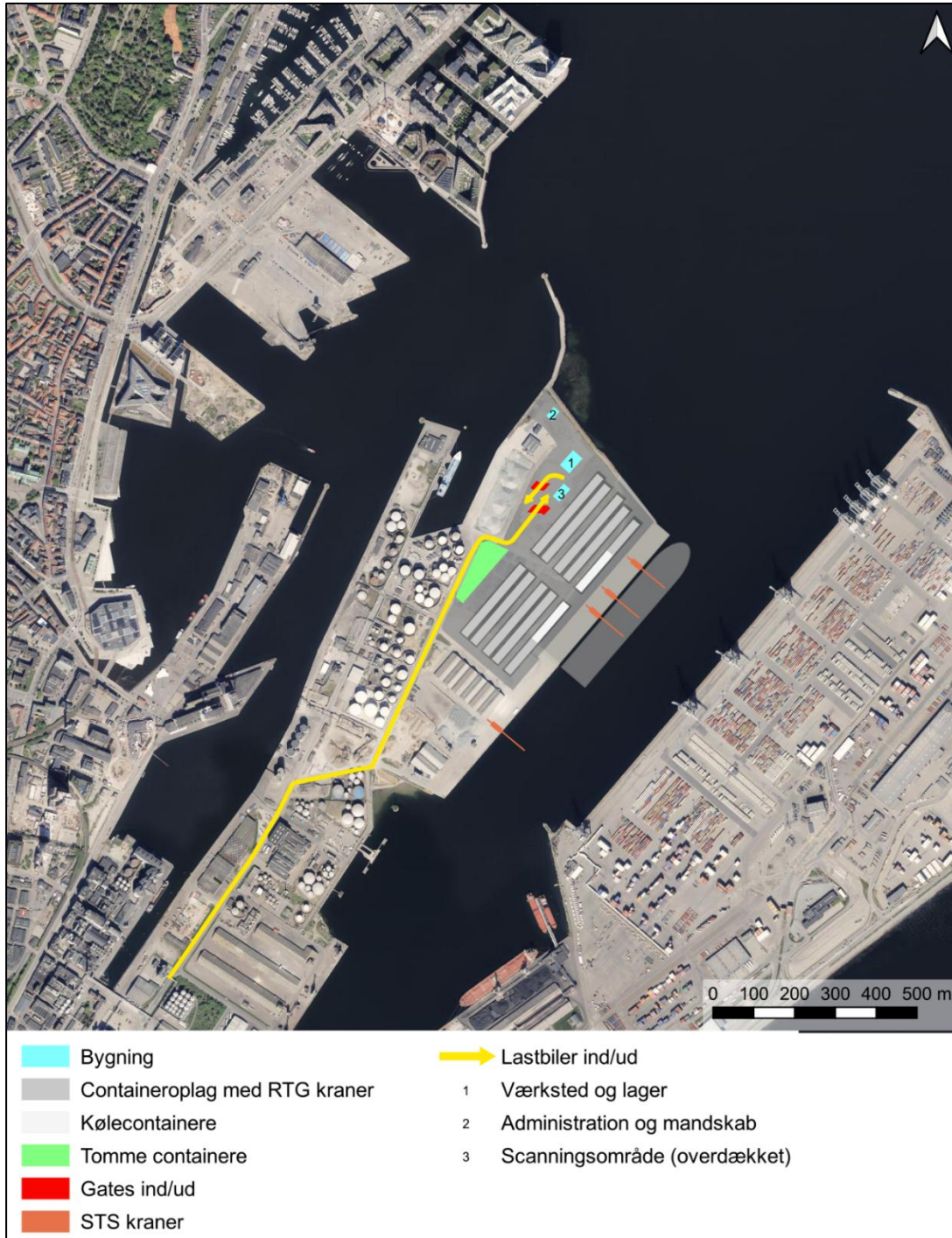
Figur 3. Skitseret indretningen af den nye containerterminal.
