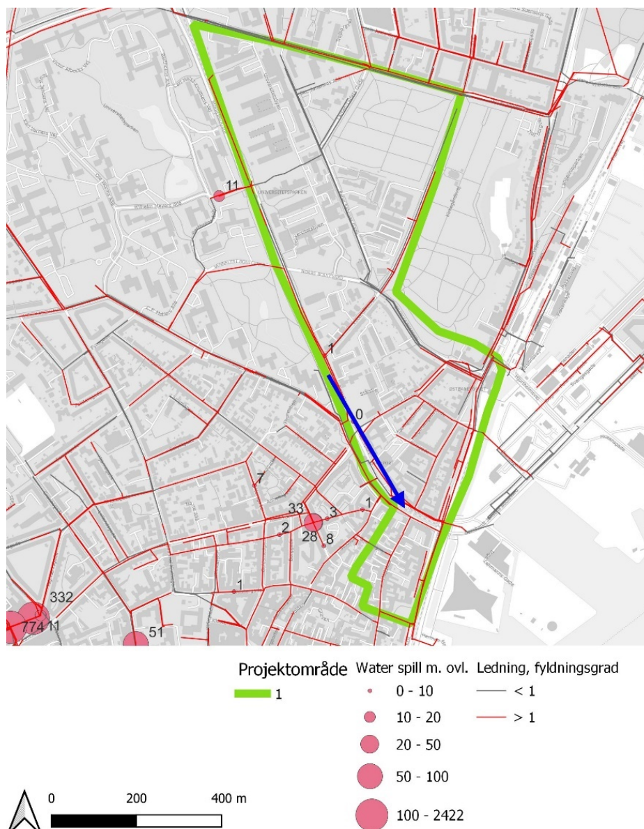
Figur 4-2. Kloakkens kapacitet, opstuvningsvolumen ved antaget 10 m \mu /s.
