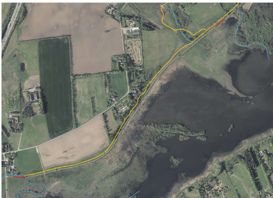
Figur 8: Oversigtskort hvor de projekterede overløbspunkter er markeret med rødt. Områdets projekterede vandløb er angivet med gult og eksisterende vandløb med blå.
