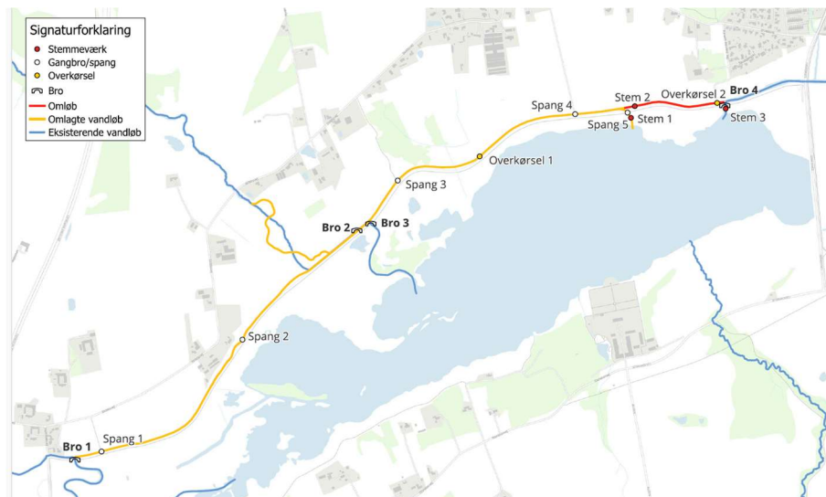
Figur 9: Oversigtskort med angivelse af placeringen af de planlagte stemmeværker samt fremtidige broer og spange. Stemmeværker er angivet med røde prikker.
