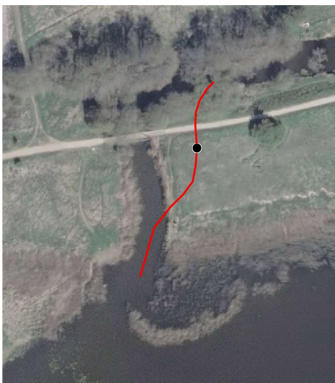
Figur 10: Oversigtskort hvor placeringen af det projekterede stemmeværk er markeret med sort og det nye afløb fra engsøen med rødt.
