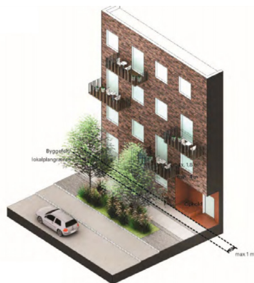
En tilbagetrukket zone, hvor man kan træde ind i boligen i læ for regnen og med mulighed for at sætte personligt præg på indgangspartiet.
