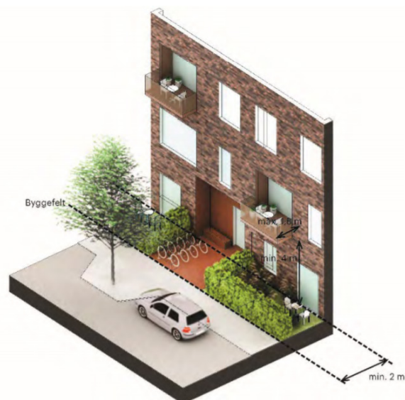
Særligt bygningernes stueetage spiller en vigtig rolle i forhold til at fremme byliv og et godt samspil mellem bygninger og gaderum. Stueetager med indgange, vinduer og kantzoner mod gader og torverum gør byen mere levende og rar at gå rundt i.
