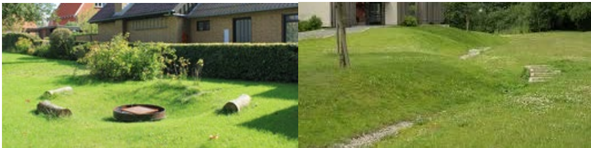
Princip for tørbassiner, der kan anvendes til forskellige aktiviteter, når det ikke regner. (Gladsaxe kommune).
