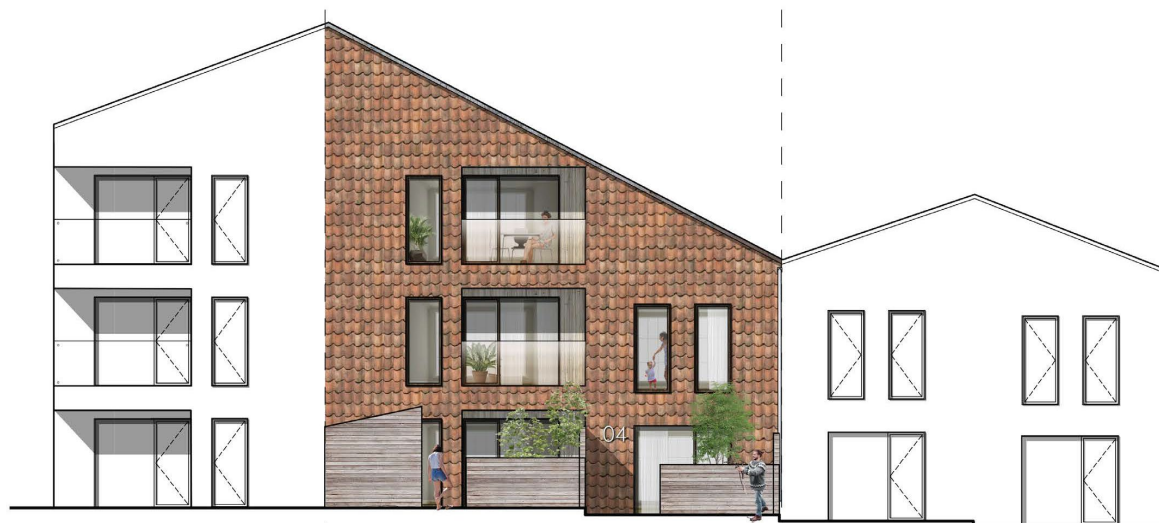
Opstalt, der viser eksempel på facade med genanvendte vingetegl.
