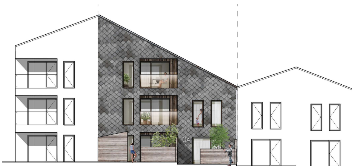
Opstalt, der viser eksempel på facade med valsede og opskårne stålplader fra lagerhal.
