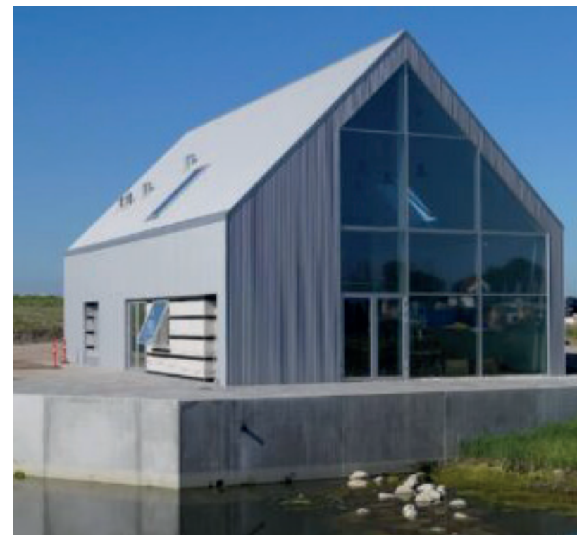
Renseværk - metalplader, ens materialer på facade og tag.
