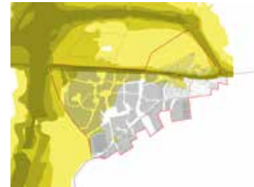
Støjkort ved udvidelse af E45 - med en 6 m støjskærm ved E45/ 4m støjskærm ved Silkeborgvej.
