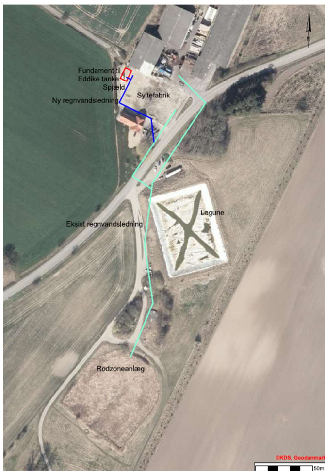
Fig.5. Oversigt over regnvandsafledning
