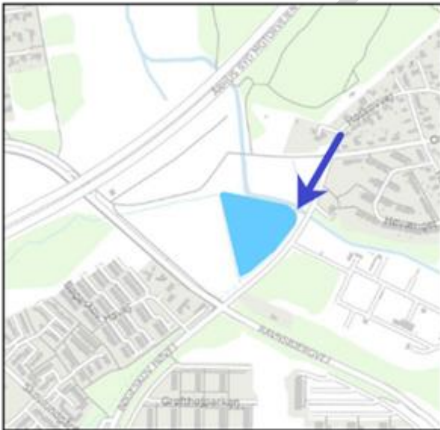
Fig. 2. Illustration af eksisterende bassin B660 ved Ormslevvej, Viby, som er markeret med blå farve. Mørkeblå pil markerer bassinets nuværende udløb til Døde Å.
