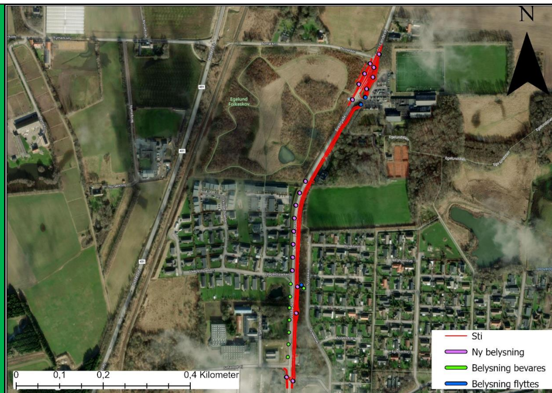
Figur 2-2. Belysning langs Bredgade.
