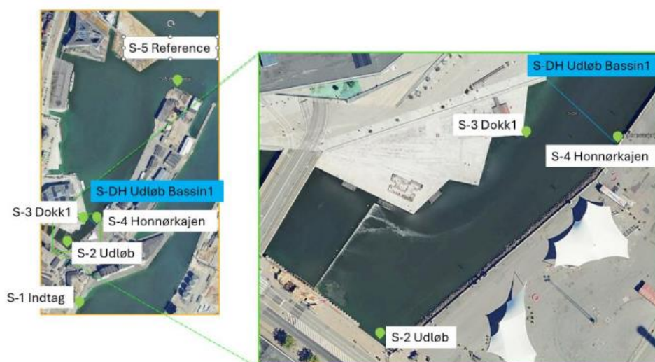
Figur 5-1: Målestationer anvendt i REF til registrering af salinitet, temperatur og ledningsevne. Fra: (DHI A/S, 2024).
